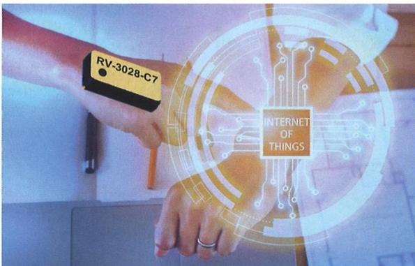
Das neue RTC-Modul RV-3028-C7 setzt einen neuen Maßstab für geringsten Stromverbrauch: 40 nA bei einer Versorgungsspannung von 3 V. Die hohe Genauigkeit von  $\pm 1$  ppm bei Raumtemperatur macht eine Kalibrierung während der Fertigung überflüssig. Das Gehäuse von nur 3,5 x 1,5 x 0,8 mm kom-
